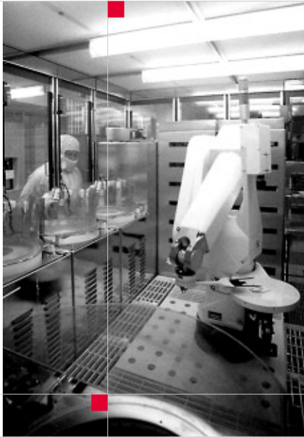
[ Fotolithographie – automatische Beschichtung von Wafern ]
