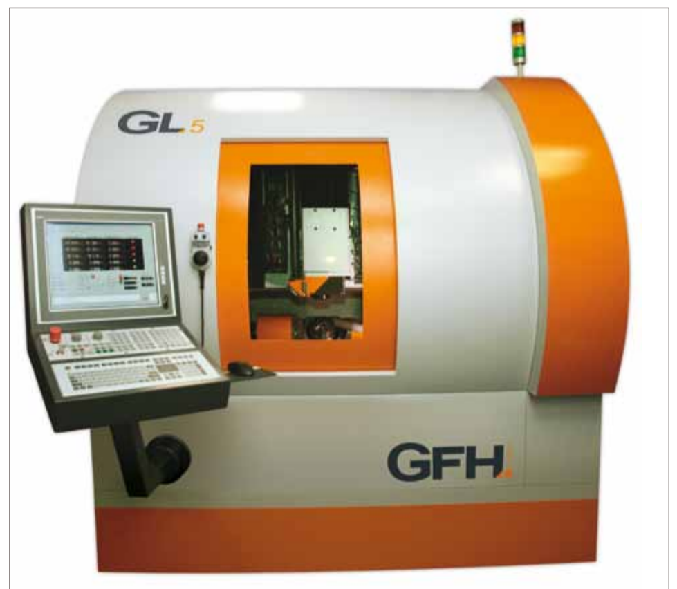
Die GL.3/5 Werkzeugmaschine kann in sämtlichen Bereichen der Lasermikrobearbeitung eingesetzt werden.
