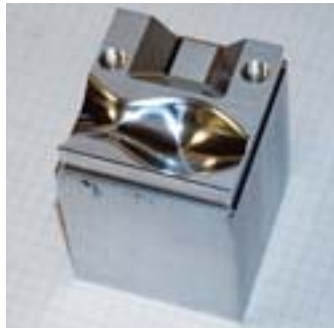
Bearbeitete Freiformflächenkontur: durch die präzise Fräsbearbeitung mit Servoone kann auf eine Schlichtbearbeitung durch Polieren verzichtet werden; Bild: Andron
