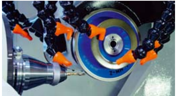
Herstellung von Hartmetallfräsern; durch die hohe Dynamik von Servoone können Maschinengeschwindigkeit und Taktrate gesteigert werden Bild: Andron
